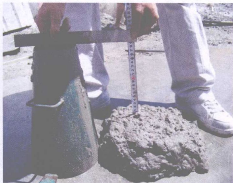
▲ 试验人员检测坍落度
