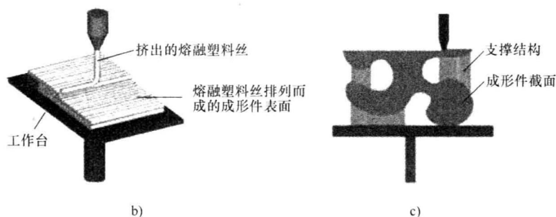
图 1-6 熔融挤压式自由成形机原理图 (续)
