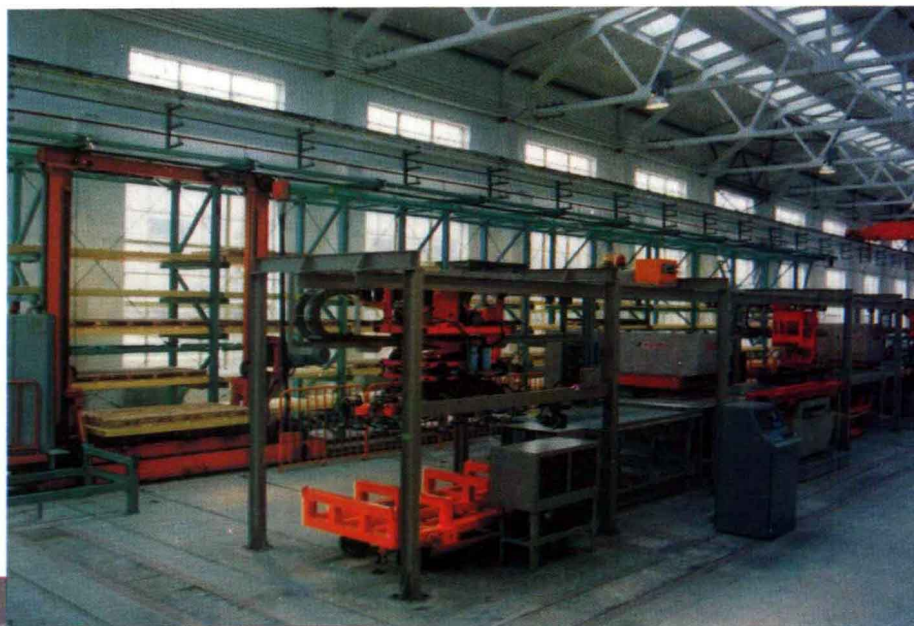
▷ 机械电子工业部济南 铸锻机械研究所研制的板 材加工柔性制造系统(FMS) (机械电子工业部科学技术司 供稿)
