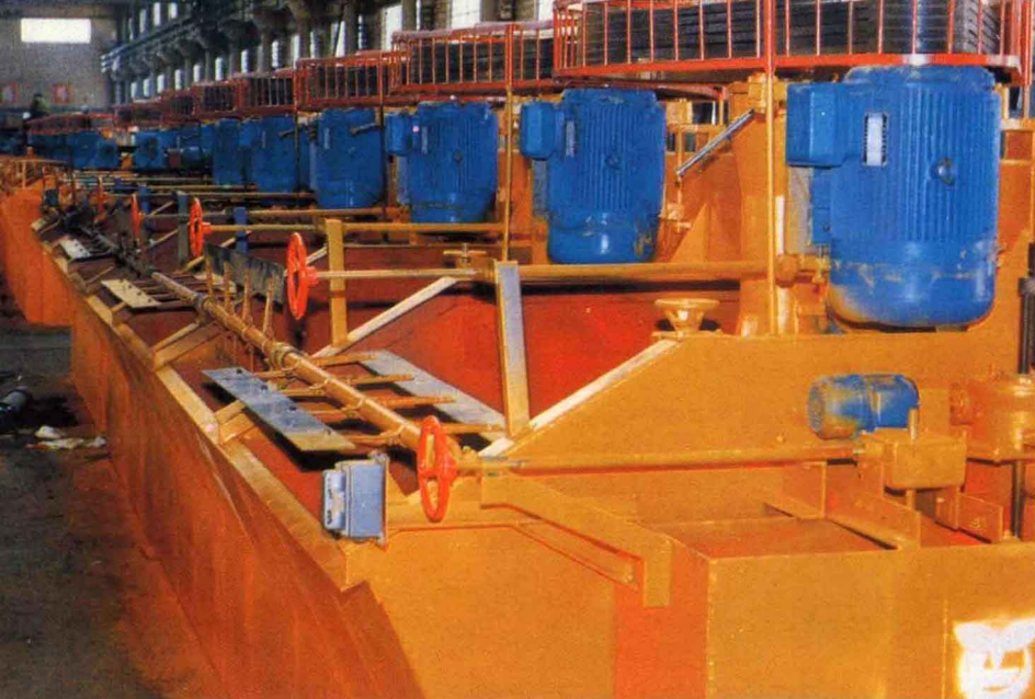
◁ 西北有色冶金机械厂生产的 38m 3 浮选机 (中国有色金属工业总公司供稿)
