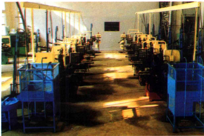
▷ 湖北第二机床厂研制的HB 2 -ZX001型 小型球轴承套圈车削自动线，获机械电子工 业部科技进步二等奖
