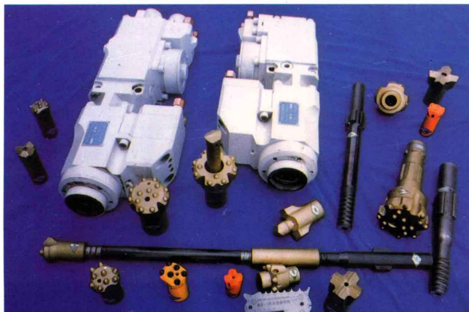
▷ 莲花山冶金机械厂生产 的 HYD 200 300 型液压凿岩机和 柱齿钎头，其中柱齿钎头获 国家银质奖
