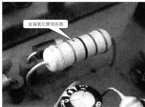
图 1-5 金属氧化膜电阻器的实物外形
