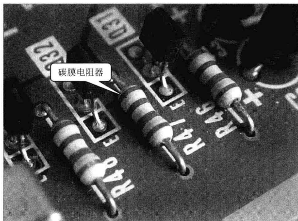
图 1-3 碳膜电阻器的实物外形
