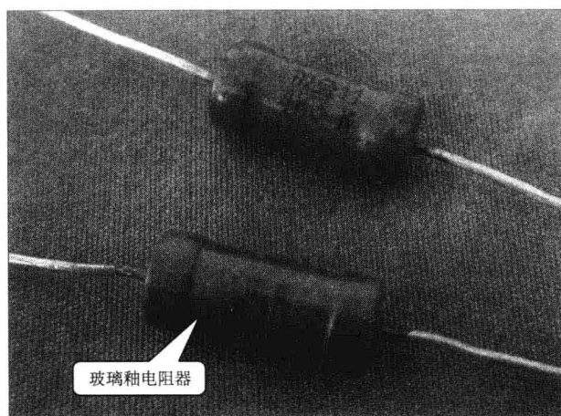
图 1-7 玻璃釉电阻器的实物外形
