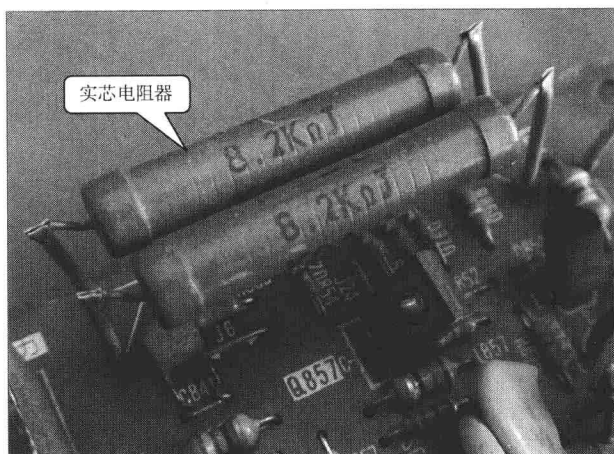
图 1-11 实芯电阻器的实物外形
