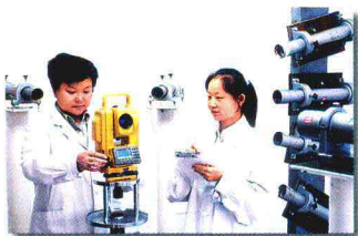
新疆测绘产品质量检验站为全疆测绘行业开展项目齐全的全站仪等测量仪器计量检定工作
