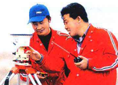
新疆第一测绘院进行 GPS 全球定位系统测量
