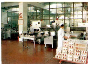
两条“利乐”生产线正在生产软包装饮料
