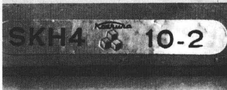
▲此图作为一种焊接车刀的侧视图。不言而喻，“SKH4”是指高速钢的第4种类型，接着是制造商的商标，接下来“10—2”指的是10型车刀，其尺寸是2号结构尺寸
