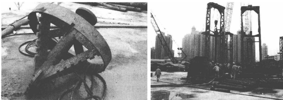
图 1-8 防斜梳齿钻头
