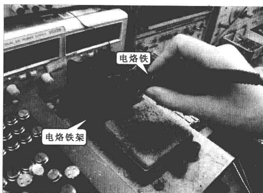
图 1-8 典型电烙铁架实物外形及应用
