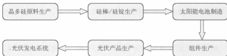
图 1-7 太阳能光伏产业链图
