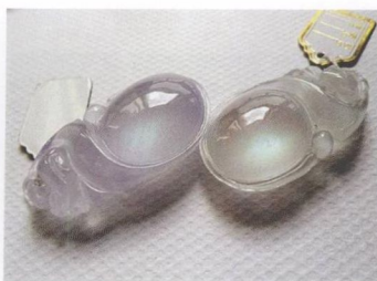
彩图80 漂白充填处理翡翠加入荧光粉假冒玻璃种翡翠
