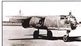
它收集到诺曼底前线大量军事情报，其数量多于以其他方式在2个月内收集到的所有情报的总和。Ar234装备简单，飞行速度极快，足以摆脱敌军的追击；驾驶室上方装有潜望镜，可以监察机身后方的情况。第二次世界大战结束以后，英国人甚至用Ar234装备他们的空军。
