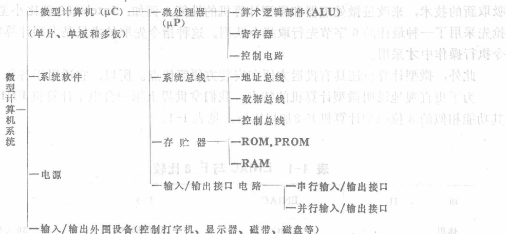
图 1-2 微处理器，微型计算机和微型计算机系统三者关系
