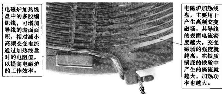
图 1-12 电磁炉加热线盘中的多股编织线实物图
