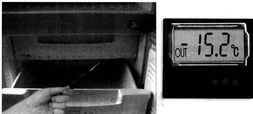
(a) 使用电子温度计检测电冰箱冷冻室的温度
