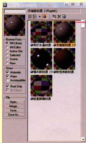
寻找丢失的材质球贴图: 选择需要的材质球, 然后双击材质球, 在贴图面板中选择漫反射贴图, 单击 Bitmap Parameters 按钮, 然后选择所需要贴图即可。
