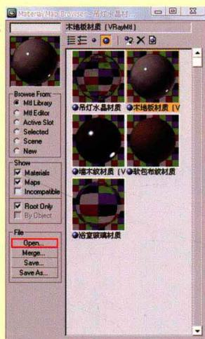
选定材质球: 打开 Autodesk 3ds Max, 键盘上的 M 键打开材质对话框, 单击 按钮, 在弹出的 Material/Map Browser (材质 / 贴图浏览器) 中选择 Mil Library 单选项, 然后在材质对话框中选择需要的材质球。
