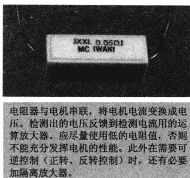
照片 1.5 用于检测电流的传感器:电阻器 3XXL0.05Ω
