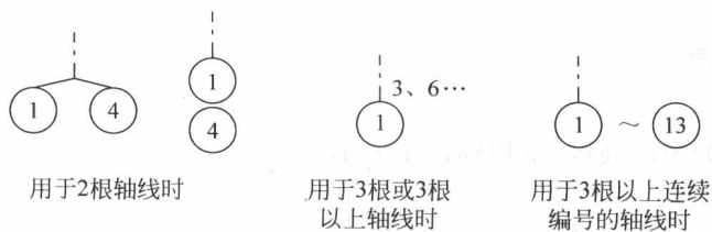
图 1-4 详图的轴线编号
