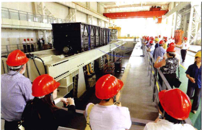
我国首台铁路货车整车疲劳与振动试验台 在齐轨道装备公司建成
