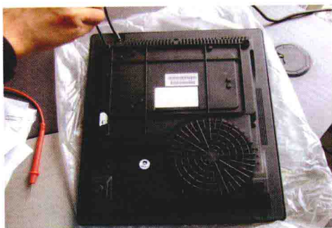
图 2 拆下电磁炉后盖螺钉
