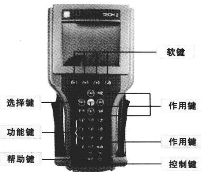
图1-18 通用汽车公司的专用诊断仪TECH-2
