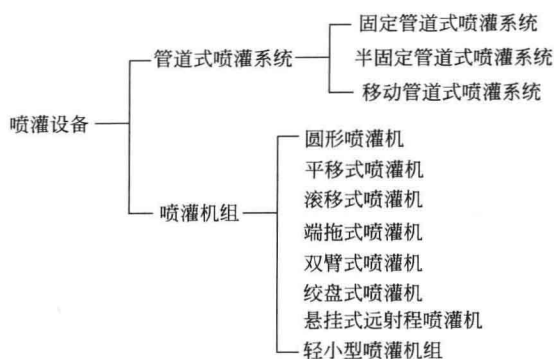
图3 喷灌设备分类示意
