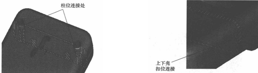
图 1-9 塑料件柱位配位要求
