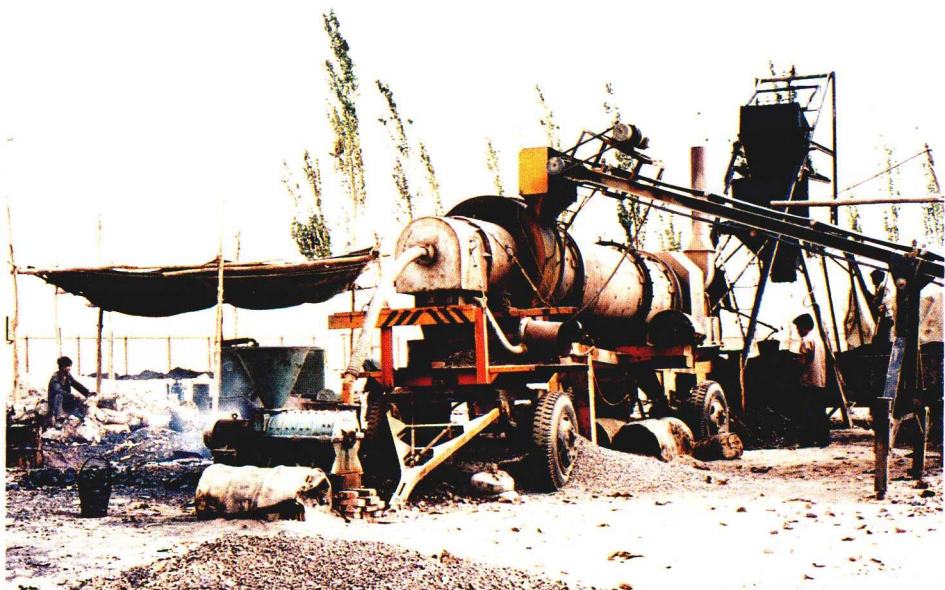
SLHB-14T 沥 青混凝土搅拌机现场 作业
