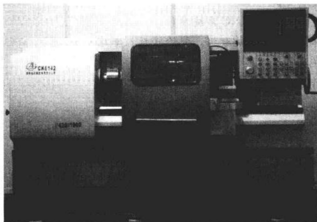
图 1—1 配置西门子 802D 数控系统的数控车床
