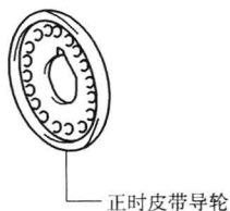
图2-3 正时皮带导轮的结构图
