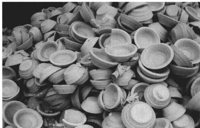
图1-40 石膏废料回收处理
