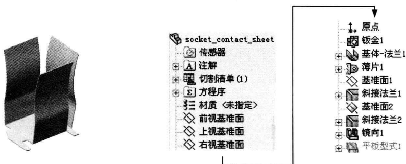
图 1.1 钣金件模型及设计树
