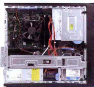
用户可以直观地看到电脑的外观组成并了解其各个部分的用途，但一台电脑的真正核心设备都是安装在主机箱中的。主要的电脑硬件设备有CPU、主板、内存、硬盘、显卡以及光驱等，当打开机箱挡板后，就可以看到这些设备了，如左图所示。
