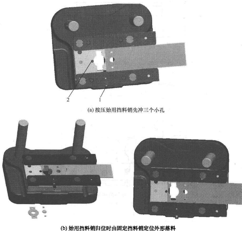
图 1-8 始用挡料销的工作原理
