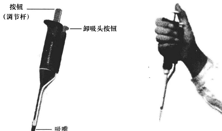
图 3 可调式移液器的结构和使用
