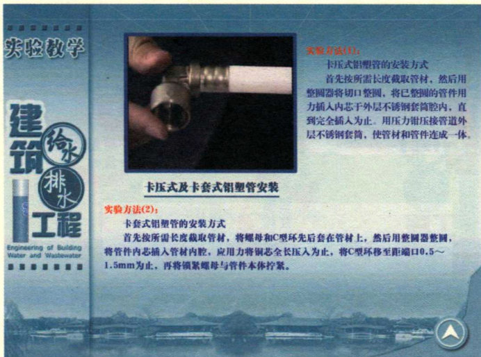
图 16 实验一 卡压式及卡套式铝塑管安装实验
