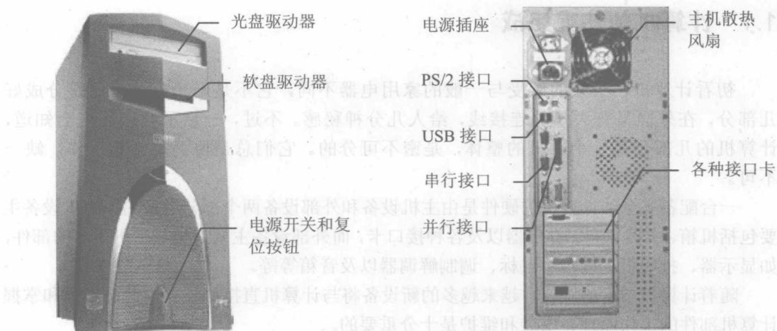
图 1-2 计算机主机的正面和背面的构成
