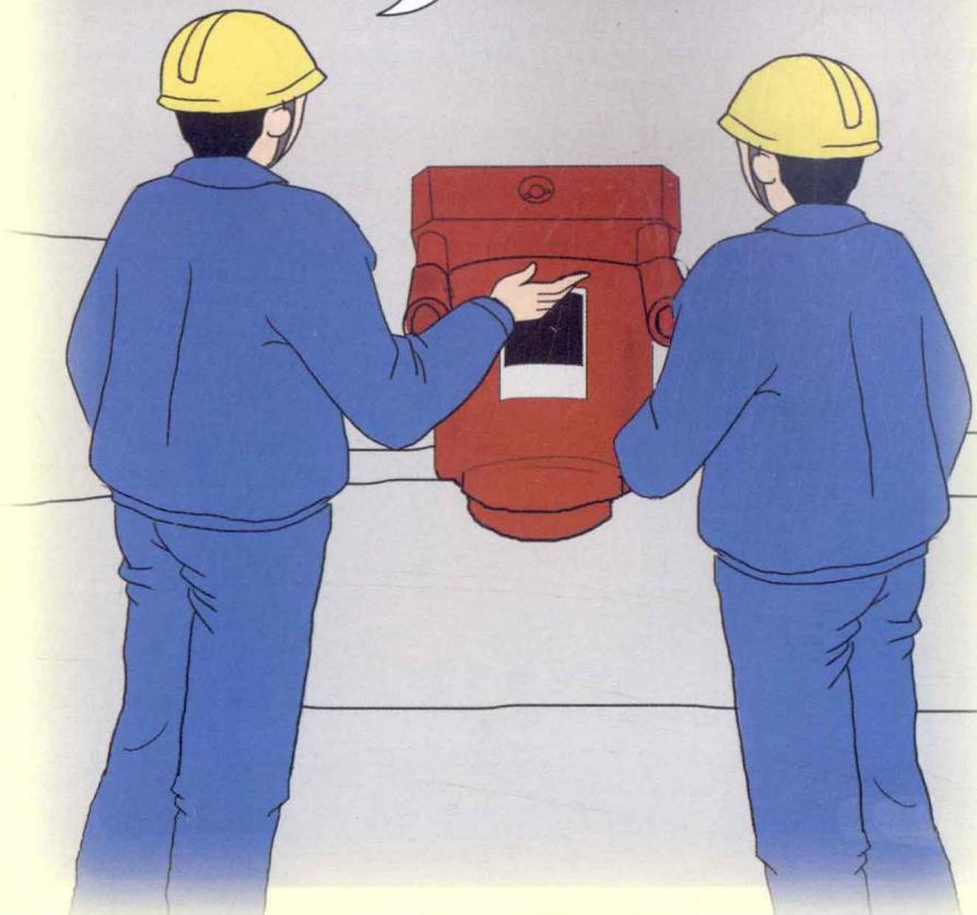
3. 液压千斤顶应按说明书要求，定时清洗和加油。立式液压千斤顶不应侧置或倒置使用。
