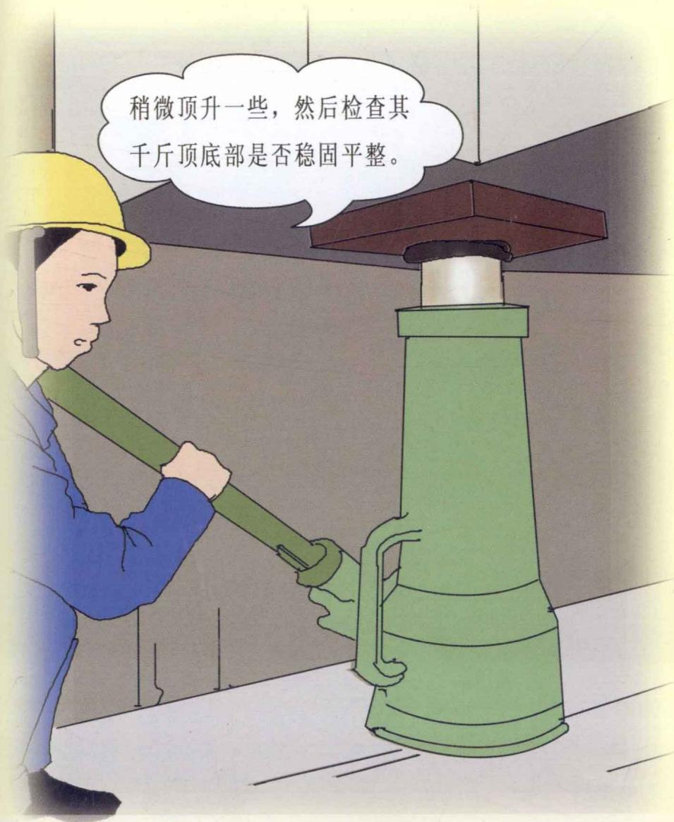
9. 千斤顶顶升重物时，应先将重物稍微顶升一些，然后检查其千斤顶底部是否稳固平整，稍有倾斜必须重新调整，直至千斤顶与重物垂直、平稳、牢固时，方可继续顶升。
