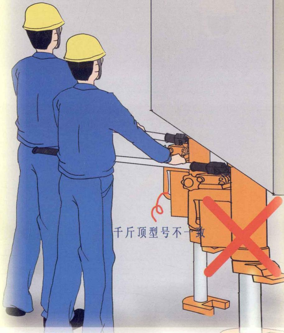
12. 一台千斤顶顶升重物时，必须掌握重物重心，防止倾倒。两台以上千斤顶顶升重物时，应尽量选用规格型式一致的千斤顶，并保持受力均匀，顶升速度相同。
