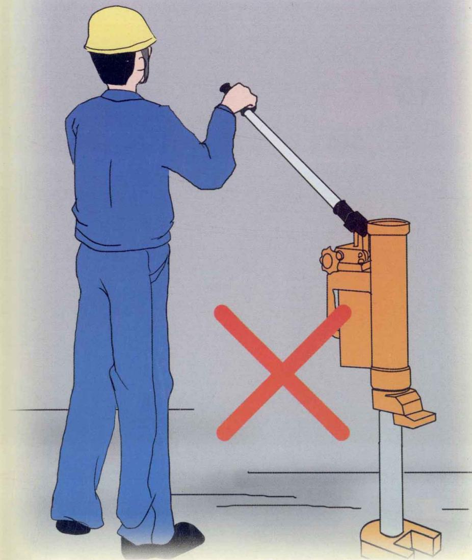
11. 千斤顶升高度不得超过限位标志线，如无标志线者，不得超过螺丝杆扣或活塞高度的 $\frac{3}{4}$ ，以免将螺杆或活塞全部升起而损坏千斤顶。
