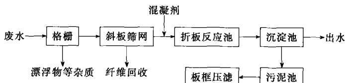
该工艺在进水 COD 为 1000~1200mg/L, SS 含量在 800~1200mg/L 的情况下，COD 的去除率  $\geq 60\%$ ，出水水质 COD 浓度小于 380mg/L, SS 小于 100mg/L，出水水质 COD 浓度略高于排放标准。该工艺的每吨废水处理费用为 0.31 元，其中药剂费 0.18 元，每日用电约 50kW·h，每度电按 0.55 元计，则每吨废水电费为 0.043 元，人工费（4 人）每吨废水 0.09 元。本方案工程总投资估算约为 28 万元。
