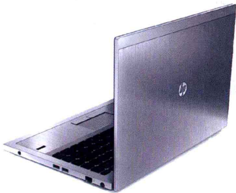
图1-3 外壳采用铝镁合金材料的笔记本电脑
