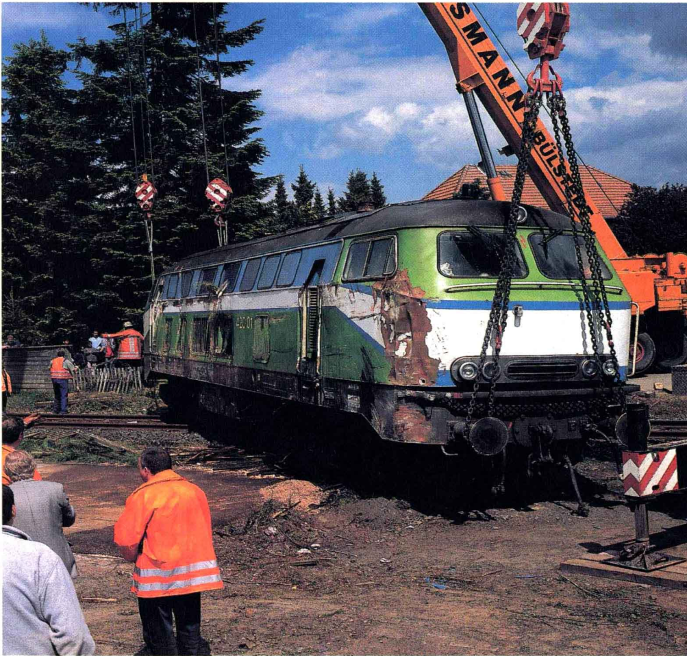
现在铁路部门对发生事故的车辆进行救援时,会增加使用公路起重机。德国联邦铁路配有专门的轨道起重机。图中发生事故的是一台私人机车。 供图:C·米勒
