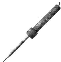
图 1-7 内热式电烙铁实际外形图
