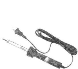
图 1-6 外热式电烙铁实际外形图
