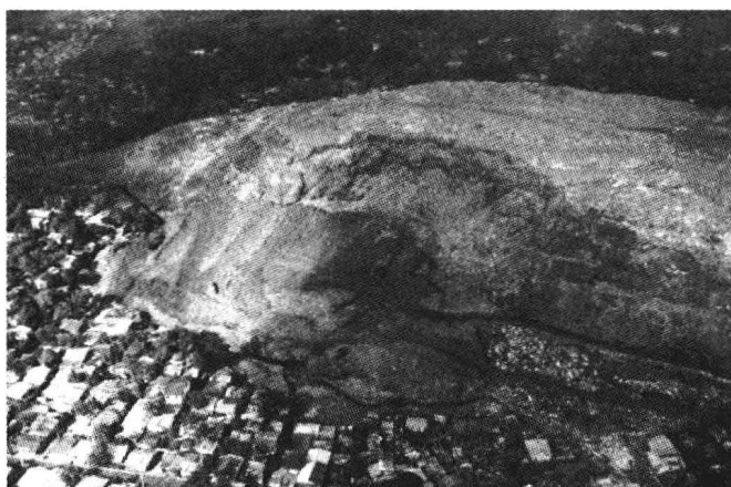
图 1.3 菲律宾奎松市(Quezon City)垃圾填埋场大面积滑坡(Kolsch et al., 2004)
