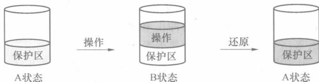
图 1-1 硬盘保护卡简单工作原理
