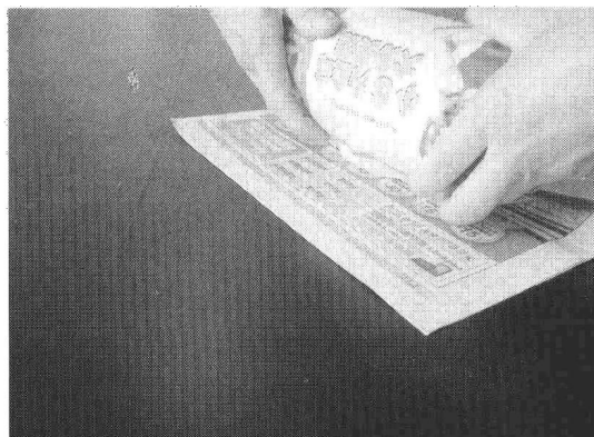
第2步 将擦好的培养皿放倒、挤紧，同时用两层报纸顺着报纸长度方向用力卷裹
