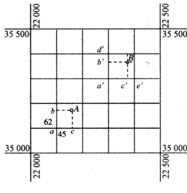
图1-8 点的平面直角坐标
