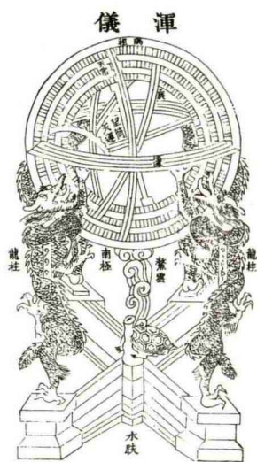
浑仪是中国古代最主要的天文测量工具之一，用于测量天体的位置。图为宋代苏颂所造浑仪示意图。
