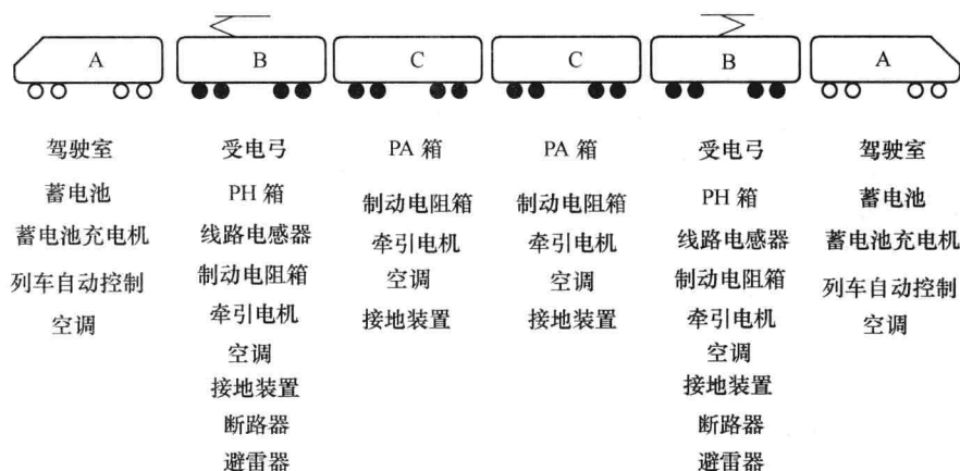
图 1-5 地铁车辆的主要设备配置
