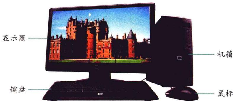
一般来说,电脑至少包括以下几部分:机箱、显示器、键盘和鼠标。随着多媒体技术的发展,音箱、耳机等也逐渐成为一种必要的外部设备,有些用户还根据自己的需要配置了扫描仪和打印机。
