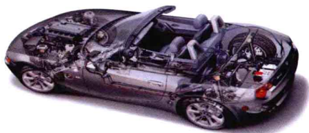
图1-20 发动机前置后轮驱动 (FR)
