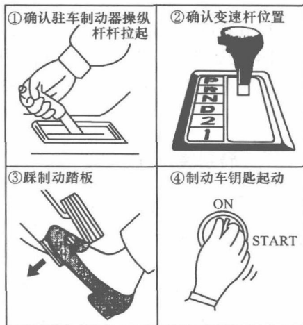
图 1-5 自动档车发动机启动步骤
