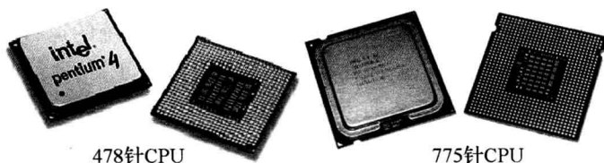
图 1-2-1 Socket 478、LGA 775 接口的 CPU
