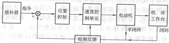
图 1-4 闭环数控系统结构
