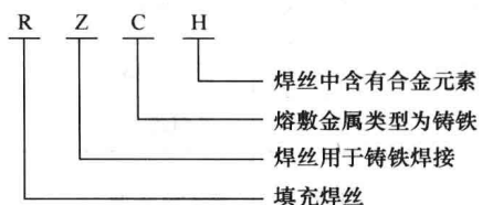
图 1—3 铁基填充焊丝型号标记示例
