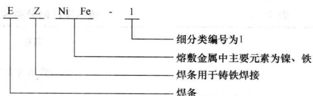
图 1—2 铸铁焊条型号标记示例二
